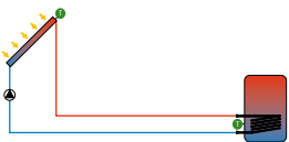
Intercambiador de calor interno, control de bombas
